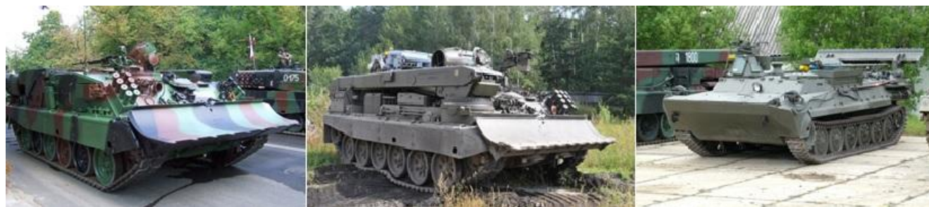
Rys. 7. Pojazdy ratownictwa technicznego WZT-3, WZT-4 oraz WPT MORS
