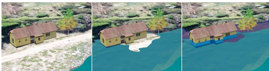
Rys. 5. Przykład wizualizacji 3D wyników modelowania hydrodynamicznego w dużej skali – zmiana położenia zwierciadła wody dla różnych wartości przepływów
