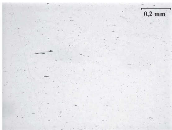
Rys. 2. Wtrącenia tlenków, siarczków i krzemianów w stali – stan nietrawiony
