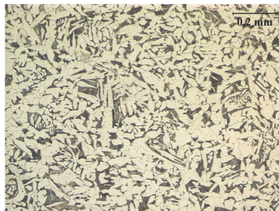
Rys. 3. Mikrostruktura materiału śruby (jasny ferryt, ciemny perlit)
