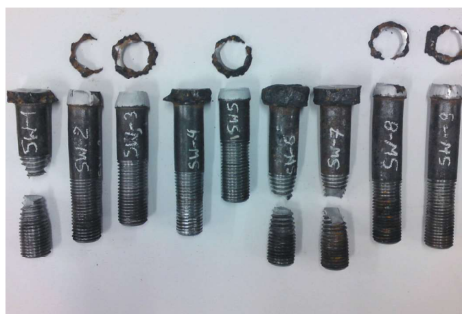
Rys. 5. Stan śrub tubingowych po badaniach wytrzymałościowych Fig. 5. Bolts after strength tests
