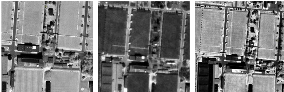
Rys. 3. Obszary wyboru punktów wiążących dla techniki korelacyjnej FBM na obrazach od lewej: Ikonos-2, Resurs-DK, QuickBird-2
