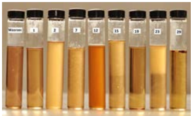
Ryc. 3. Próbkki domieszek po badaniu starzeniowym
