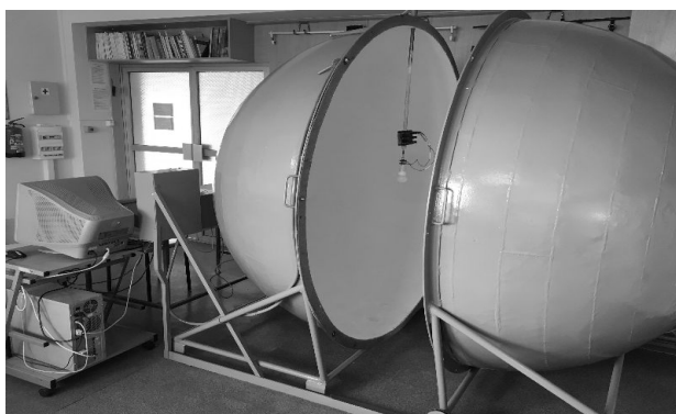
Rys. 2. Stanowisko pomiarowe do pomiarów parametrów fotometrycznych i elektrycznych
