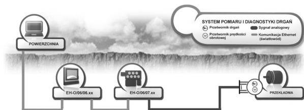
Fig. 3. Exemplary architecture of EH-Wibro system implementation Rys. 3. Przykładowa architektura systemu EH-VIBRO
