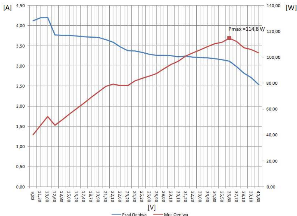
Rys. 4. Przykład charakterystyki badanego modułu fotowoltaicznego uzyskanego na stanowisku pomiarowym [12]
