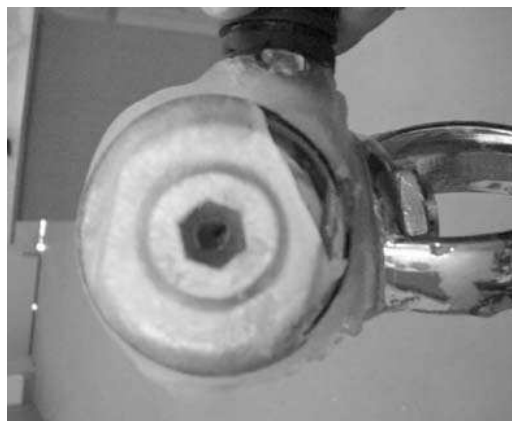
Rys. 2. Oblodzony 1 stopień automatu.
