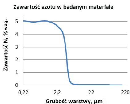
Rys. 3. Próbkę nr 1 obszar 1 – zawartość azotu w warstwie azotowanej
