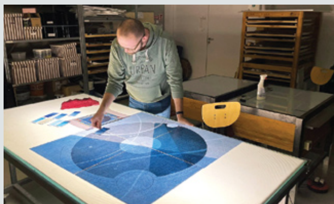
Fot. 3. Dobieranie odcienia barwnej patyny do witraża zgodnie z projektem
