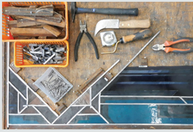
Fot. 6. Proces składania elementów witraża w ołów
