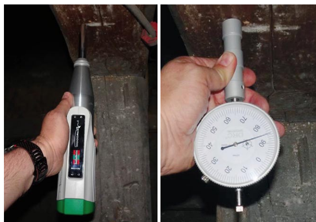
Rys. 6. Badanie młotkiem Schmidta do drewna (wieszak więźby wieszarowej)
