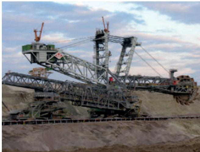
Rys. 1. Ustrój nośny koparki SchRs 4000 firmy Orenstein & Koppel zbudowanej w 1984 roku Fig. 1. The load carrying structure of BWE Type SchRs 4000 (built in 1984 by O&K/LMG)
