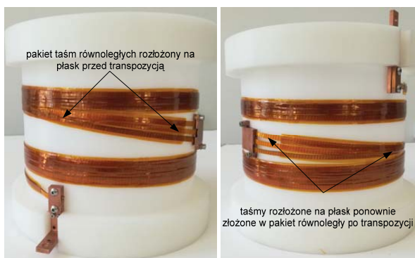
Rys. 13. Taśmy rozłożone na płask przed i po transpozycji
