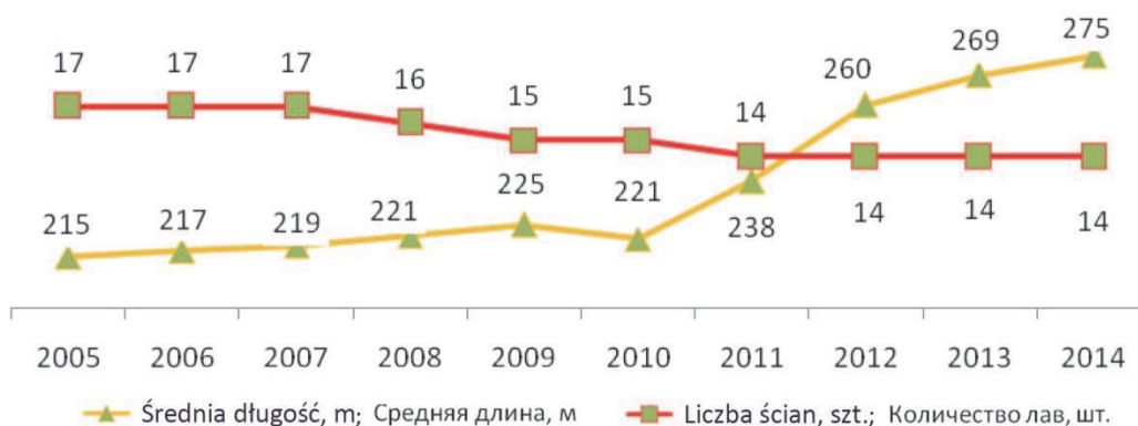
Rys. 4. Zakres zmiany liczby przodków wybierkowych przy zwiększeniu długości przodków wybierkowych i filarów eksploatacyjnych [2]
