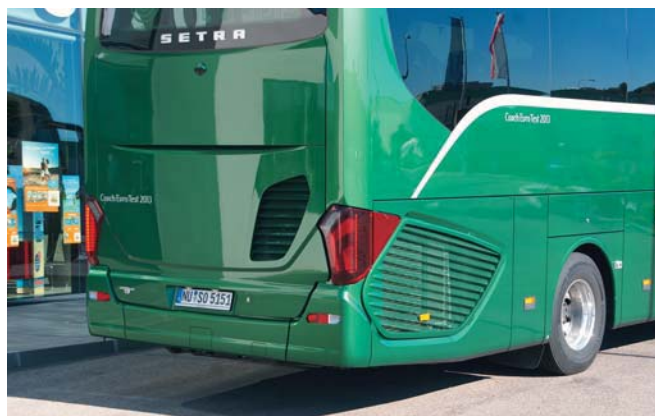
Tyłna część pojazdu z charakterystycznymi wlotami powietrza gwarantującymi właściwe chłodzenie silnika Euro 6
