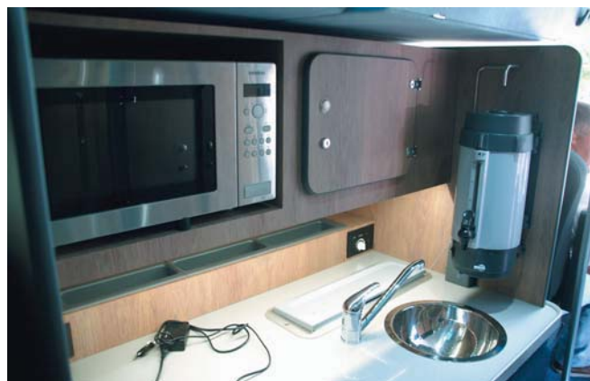
W Van Hool Astromega tuż za kabiną kierowcy zamontowano kuchnię umożliwiającą serwowanie drobnych przekąsek
