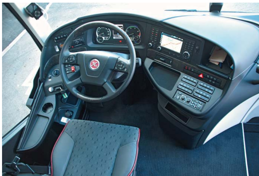
Stanowisko kierowcy z multifunkcyjną kierownicą i dużym ekranem obsługi pokładowego systemu multimedialnego
