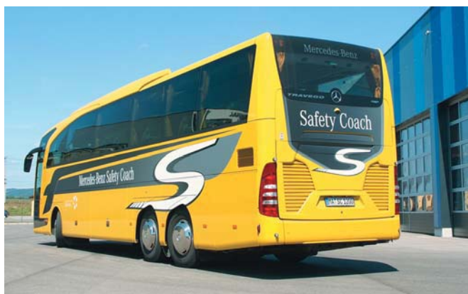
Kłapa silnika z dużymi wlotami powietrza – jednak tylko wlot po prawej stronie zapewnia dopływ powietrza do komory silnika, drugi jest maskownicą umieszczoną w celach estetycznych
