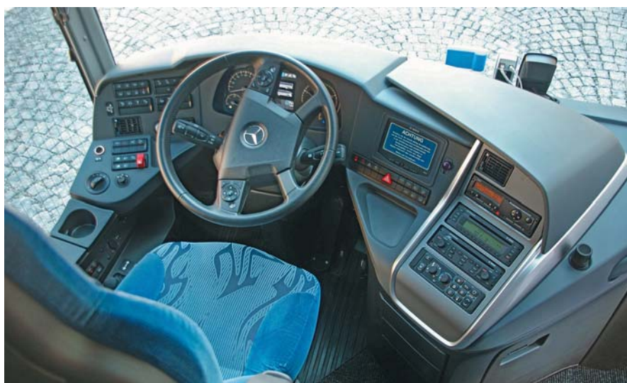
Nowa deska rozdzielcza kierowcy, z powierzchni której zniknął charakterystyczny joystick sterowania skrzynią biegów, zastąpiony zintegrowaną dźwignią na kolumnie kierownicy
