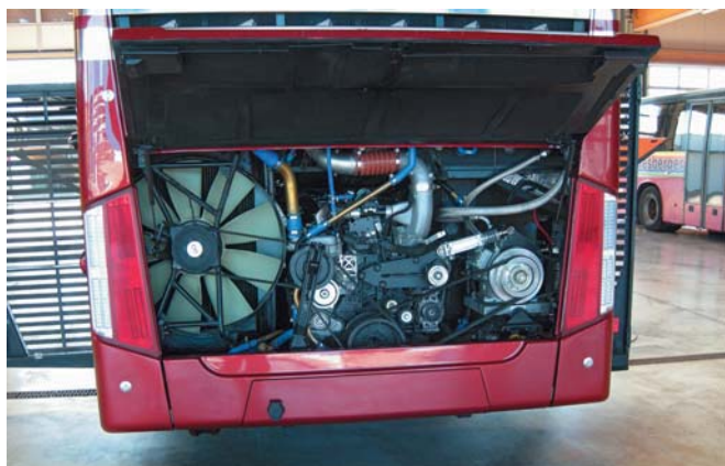
Komora silnikowa w autobusie Van Hool
