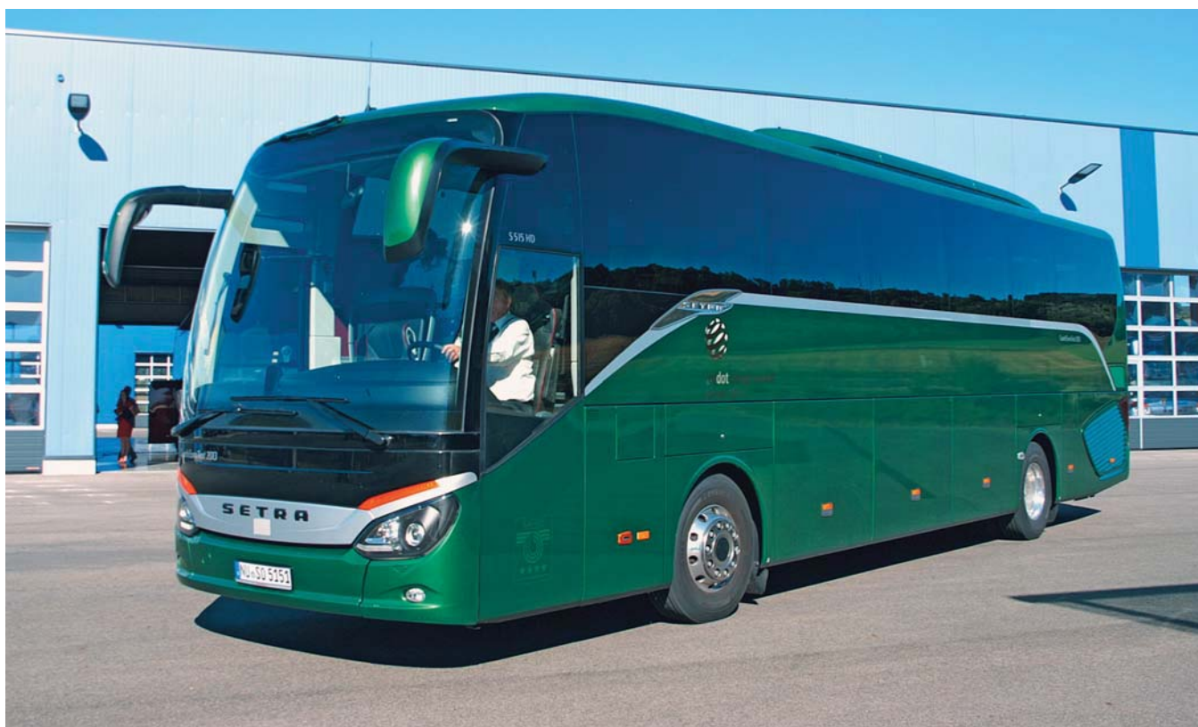
Przednia ściana to jeden z elementów posiadających wpływ na aerodynamikę pojazdu
