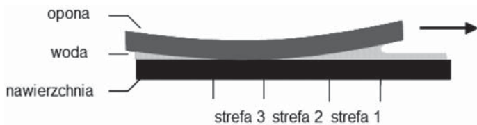
Rys. 8. Strefy kontaktu opony z mokrą nawierzchnią (źródło: [11])
