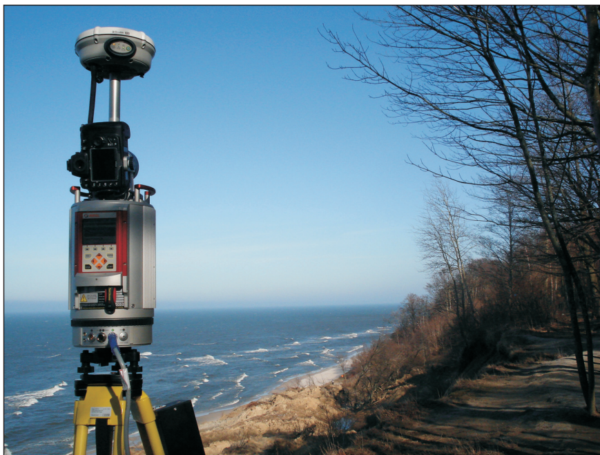
Fig. 4. Skaner laserowy Riegl VZ-400 w trakcie skanowania osuwiska na klifie Jastrzębiej Góry (fot. J. Frydel)
