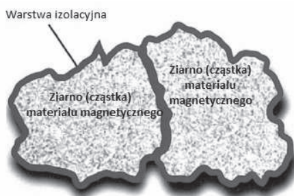
Rys 1. Schemat budowy magnetycznego materiału kompozytowego [2]
