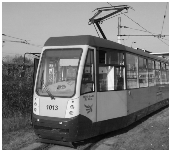
Fot. 1. Badany tramwaj typu 105N z zasobnikiem superkondensatorowym
