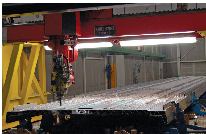
Fot. 4. Podłoga w trakcie frezowania otworów przepustowych dla instalacji
