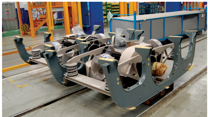
Fot. 8. Silniki trakcyjne pierwszego pociągu przed montażem; widoczna rama napędu i odsprężynowanie
