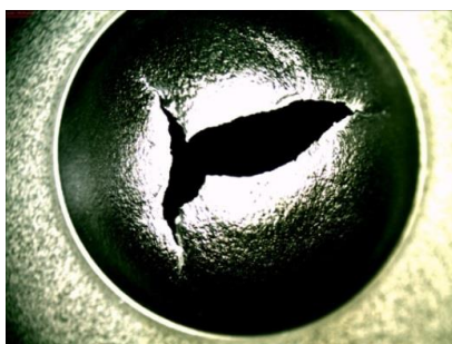
Rys. 5. Podłoże stalowe po pięciokrotnym uderzeniu
