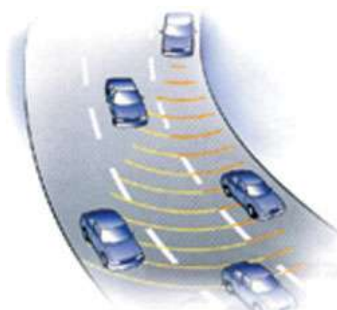
Rys. 1.1. Działanie układu automatycznego utrzymywania bezpiecznego odstępu [5]
