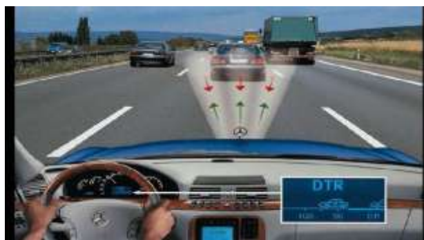
Rys. 1.2. Adaptacyjna regulacji prędkości jazdy (ang. Adaptive Cruise Control – ACC) [5]
