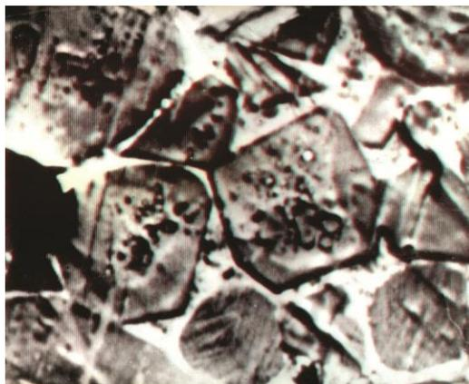
Рис. 2. Микроструктура клинкера с глиногипсом
