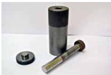
Rys. 5. Widok matrycy do prasowania paliw (o średnicy 23 mm)
