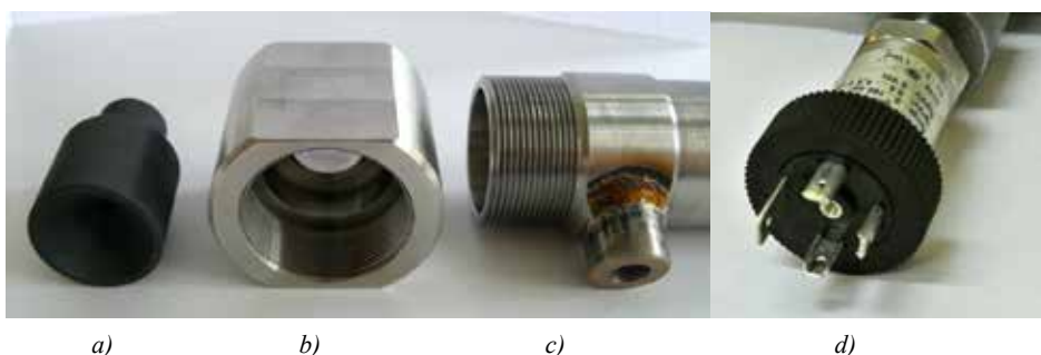
Rys. 2. Widok części silnika laboratoryjnego do badania paliw: a) dysza wylotowa, b) głowica silnika, w której umieszczana jest dysza, gwintowana końcowa część korpusu umożliwiająca dokręcenie głowicy, c) króciec pomiarowy do montażu przetwornika ciśnienia, d) piezorezystancyjny czujnik ciśnienia
