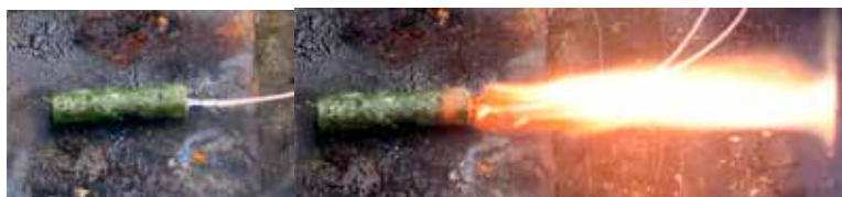
Rys. 7. Przykład inicjowania zapłonu próbki paliwa Sz – za pomocą główki zapalczej wraz z masą pirotechniczną PS
