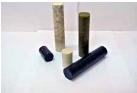
Rys. 6. Przykładowe wypraski paliwa przygotowane do badań w silnikach laboratoryjnych
