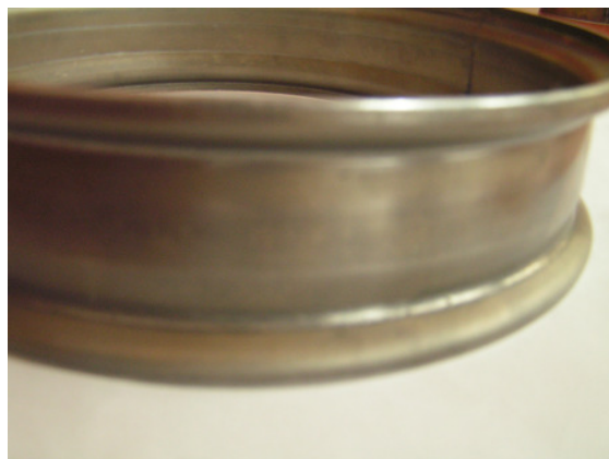
Rys. 6. Prawidłowe obręcze spełniające warunki odbioru technicznego Fig. 6. Correct rings meeting the technical acceptance requirements
