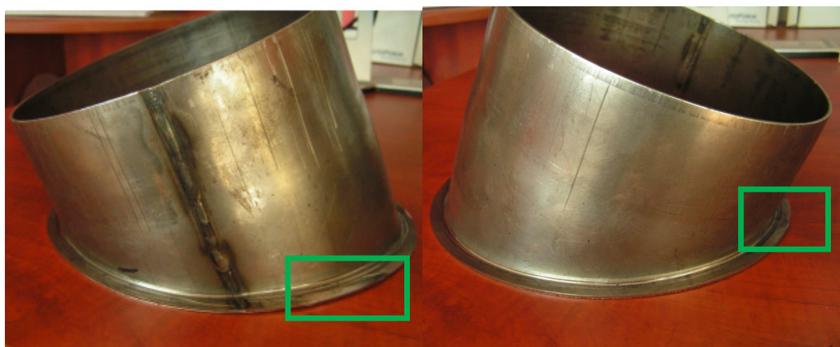
Rys. 9. Elementy układów kominowych z ukształtowanym kołnierzem niespełniające warunków odbioru technicznego (kolorem zaznaczono wady w postaci rys i wgłębień)
