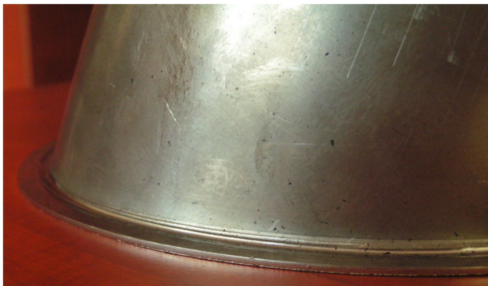
Rys. 12. Końcowy wyrób – pospawana rura z ukształtowanym kołnierzem spełniająca warunki odbioru technicznego zawarte w zapytaniu ofertowym klienta
