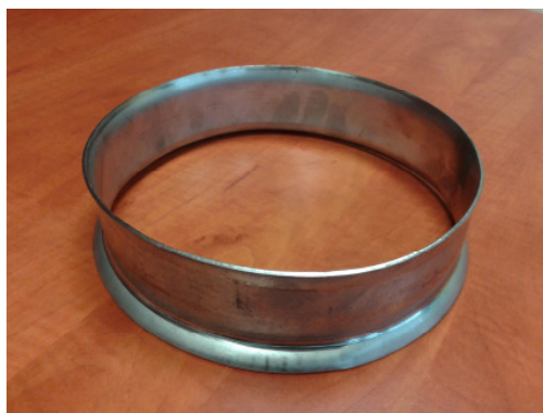
Rys. 4. Obręcze po pierwszych próbach – nie spełniają warunków odbioru technicznego
