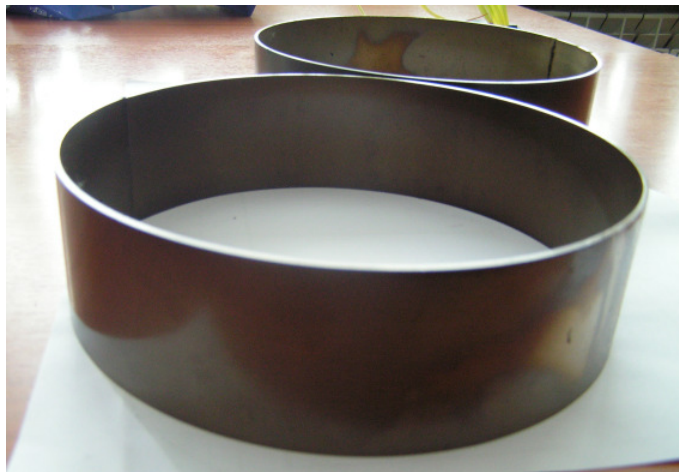
Rys. 5. Obręcze po obróbce cieplnej (przesyceniu) przygotowane do prób kształtowania Fig. 5. Rings after heat treatment (solution heat treatment) prepared for the tests of forming
