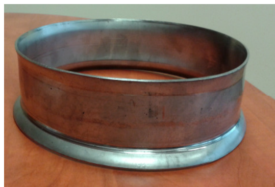
Rys. 4. Obręcze po pierwszych próbach – nie spełniają warunków odbioru technicznego
