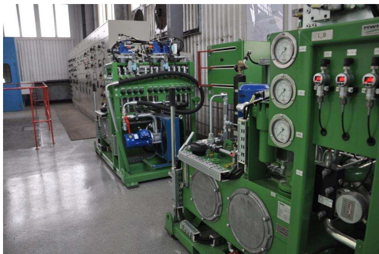
Rys. 3. Dwuagregatowy zespół sterowniczo-zasilający tarczowego hamulca maszyny wyciągowej [8]
