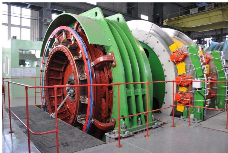
Rys. 1. Maszyna wyciągowa 4L-4000/3900 [8]
