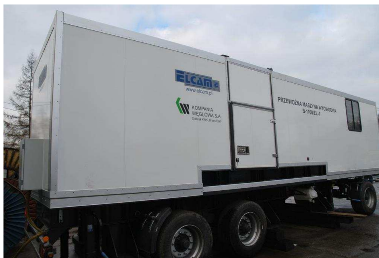
Rys. 7. Przewoźna maszyna wyciągowa B-1100/EL-1 [8]
