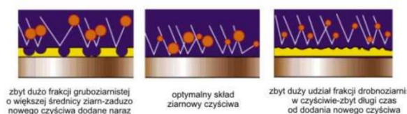
Rys. 9. Wpływ wielkości ziarna na stopień oczyszczania [4]
