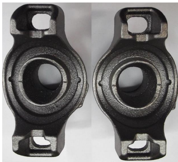
Rys. 10. Po lewej odlew wyczyszczony po 15 minutach, po prawej po 25 minutach
