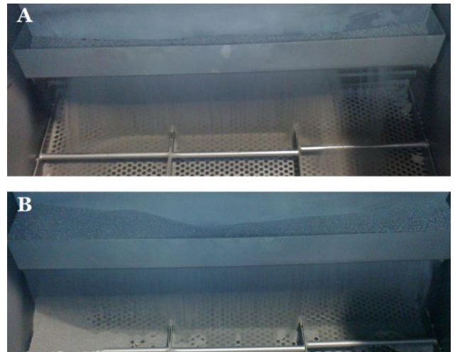
Rys. 7. a - kurtyna słabo obciążona z nieregularnym rozłożeniem śrutu, b - kurtyna dobrze obciążona z regularnym rozłożeniem śrutu [1]
