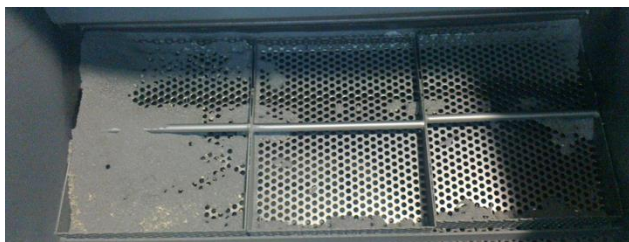
Rys. 6. Zanieczyszczone sito górne [1]
