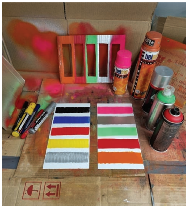
Rys. 4. Stanowisko badawcze do oznaczania odporności na graffiti [fot. M. Garbacz]
