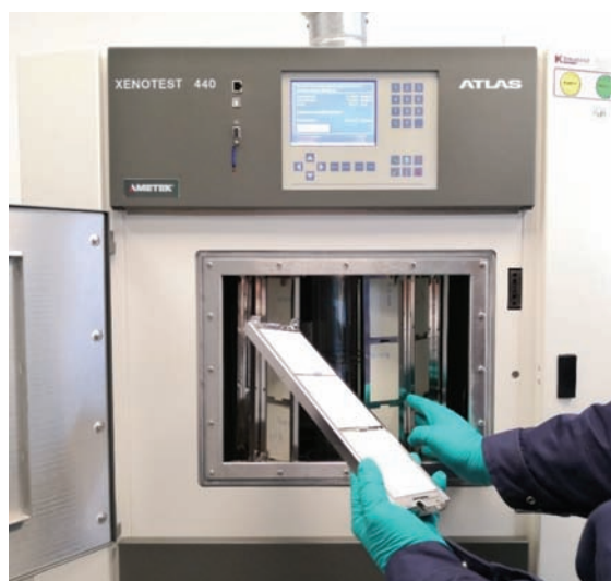
Rys. 1. Stanowisko badawcze do starzenia próbek według ISO 16474-2 [7] (komora świetlna, Atlas GmbH Xenotest 440) [fot. M. Garbacz]
