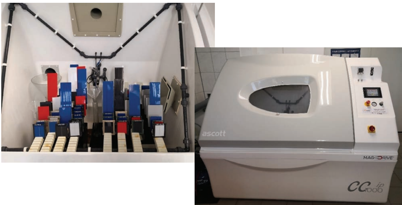
Rys. 3. Stanowisko badawcze do starzenia próbek według PN-EN ISO 9227 [12] (komora solna Ascott CC1000IP) [fot. M. Garbacz]
