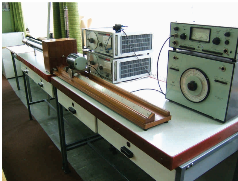
Ryc. 2. Widok aparatury pomiarowej do wyznaczania fizycznego współczynnika pochłaniania dźwięku [2]
