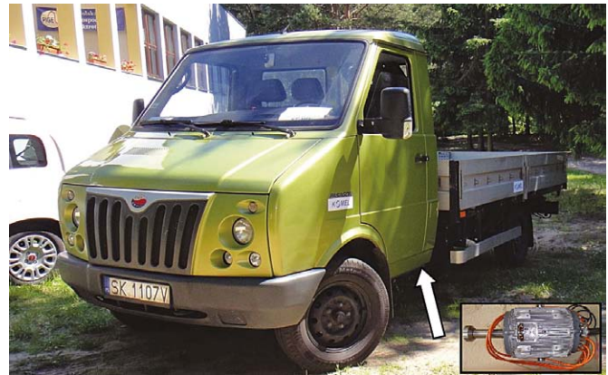
Rys. 4. Samochód o napędzie hybrydowym bimodalnym spalinowo-elektrycznym
