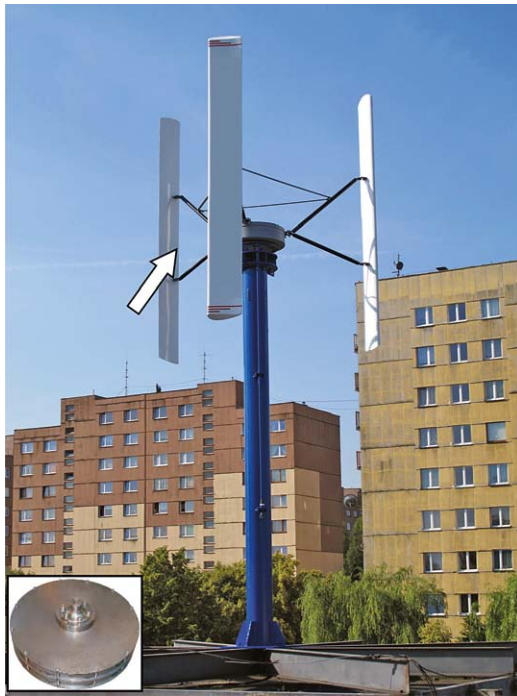
Rys. 16. Przykładowe zastosowanie prądnicy z magnesami trwałymi z wirnikiem zewnętrznym
