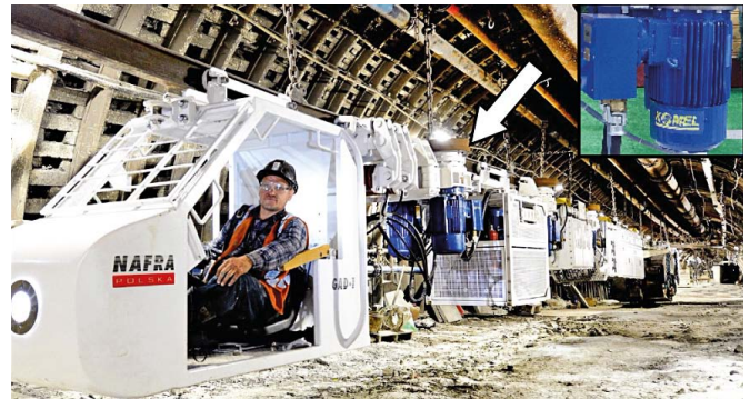
Rys. 12. Kolejka GAD-1 z silnikiem z magnesami trwałymi
