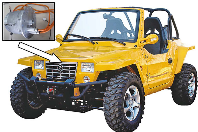
Rys. 8. Pojazd sportowo-rekreacyjny [24] napędzany silnikiem z magnesami trwałymi
