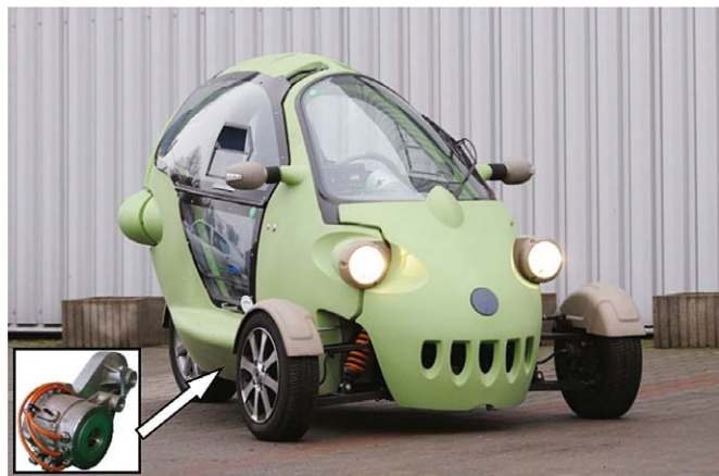
Rys. 1. Samochód Re-Volt z silnikiem elektrycznym o mocy 14,9 kW
