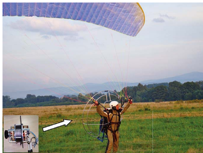
Rys. 9. Prototypowa paralotnia plecakowa z napędem elektrycznym
