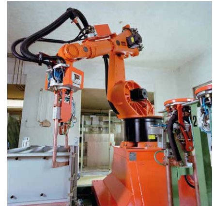
Rys. 2. Zgrzewanie szaf stalowych w firmie Stähli (Źródło: KUKA)
