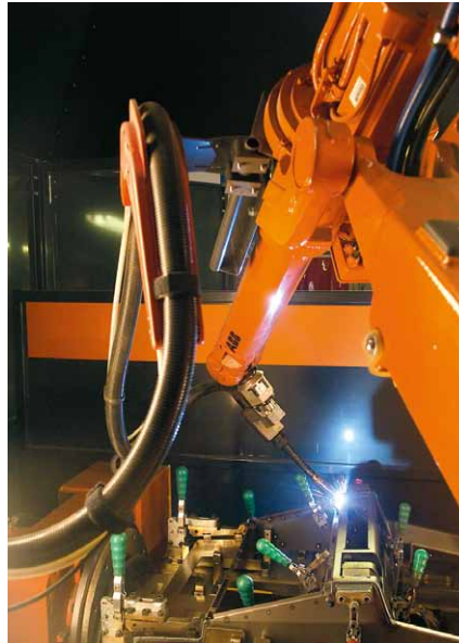
Rys. 1. Proces spawania robotem przemysłowym (Źródło: ABB)
