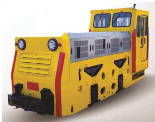
Rys. 1. Wąskotorowa lokomotywa powierzchniowa WLP-50EM/H [4]
