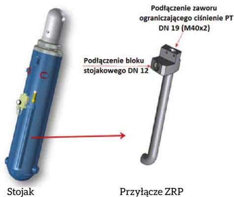
Rys. 4. Rysunek poglądowy stojaka oraz przyłącza ZRP [8]
