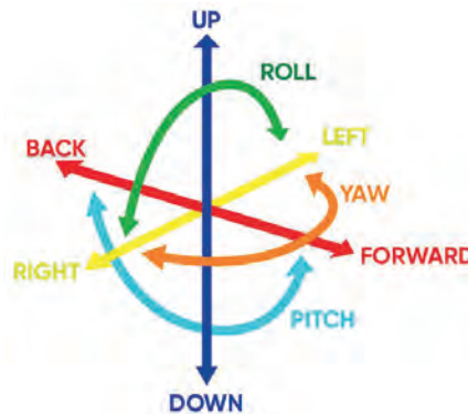
Ryc. 6 Schemat przedstawiający dostępne osie korekty pacjenta w systemie 6DoF Źródło: [13].
