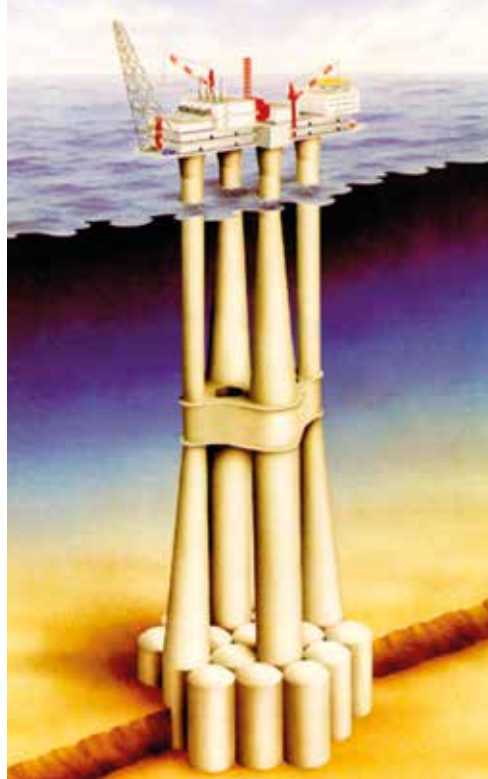
Rys. 4. Troll – platforma wiertnicza na Morzu Północnym. Szyby formowane ślizgowo przy użyciu ligno-sulfonianu jako plastyfikatora i CN dla optymalizacji szybkości wyciągania bez podnoszenia maksymalnej temperatury
