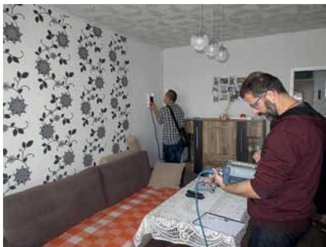
Rys. 14. Pomiar georadarem przestrzeni dylatacyjnej pomiędzy przegrodami pionowymi, realizowany w jednym z mieszkań
