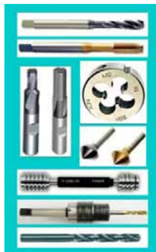
Rys.10. Asortyment narzędzi ze stali szybkoobrotowych.
