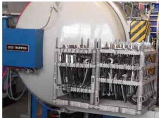
Rys.5. Ułożenie narzędzi chirurgicznych we wsadzie
