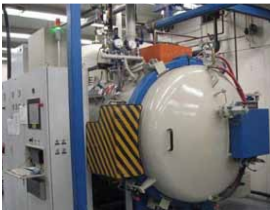
Rys.3. Piec próżniowy do ulepszenia cieplnego matryc i stempli, Seco/Warwick typ 15.0VPT-4025/24HV.
