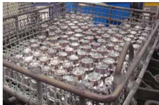
Rys.4. Matryce mieniczne umieszczone w koszu, po obróbce cieplnej.
