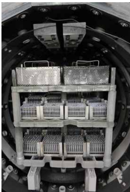
Rys.11. Władz złożony z narzędzi do gwintów w komorze pieca Seco/Warwick 10.OVPT-4035/36
