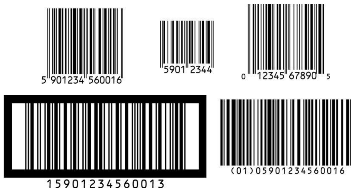
Rys. 4. Przykłady kodów kreskowych, przedstawiające numery GTIN: EAN-13, EAN-8, UPC-A, ITF-14, GS1-128 z IZ 01 (Źródło: Opracowanie własne ILiM)
