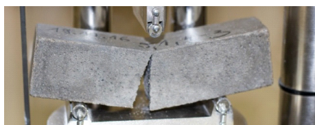
Rys. 1. Próbkę betonu BWW po badaniu wytrzymałości na zginanie
