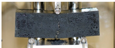
Rys. 2. Próbkę betonu RPC po badaniu wytrzymałości na zginanie
