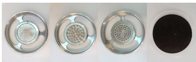
Rys. 1. Filtry z poszczególnych stopni impaktora kaskadowego firmy Dekati
