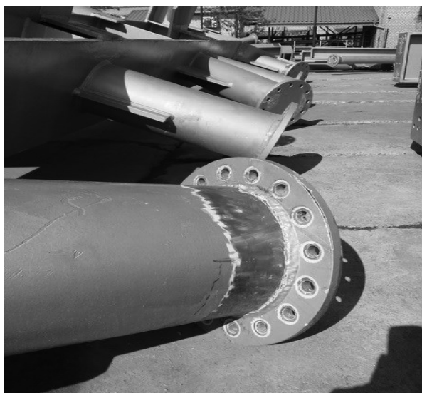
Rysunek 4. Odpowiednio przygotowana do badań spoina. Źródło: Jedna z analiz konstrukcji stalowych wykonywanych przez Centrum Rzeczoznawstwa Budowlanego Sp. z o.o.
