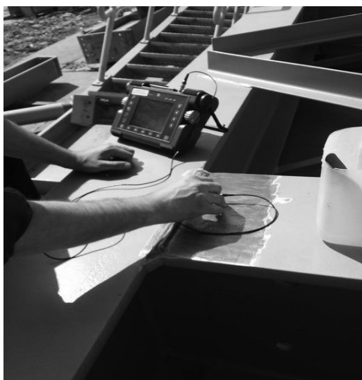
Rysunek 2. Badanie przeprowadzane metodą echa przy udziale pojedynczej głowicy.
