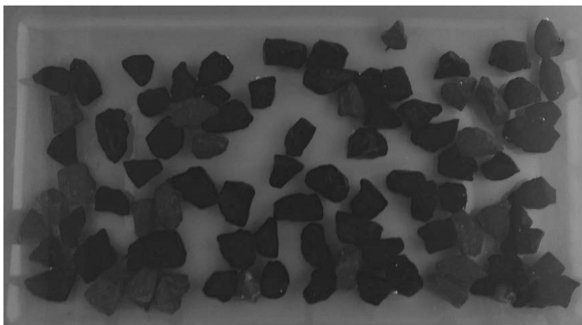
Rys. 3. Próbką kruszywa bazaltowego zawierająca 75% ziaren otoczonych lepiszczem
