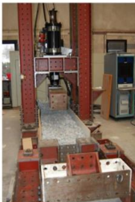
Rys. 3. Stanowisko badawcze powierzchni kontaktu podrozdnic z ziarnami tłucznia
