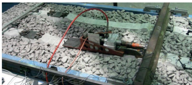
Rys. 4. Stanowisko badawcze oporu porzecznego podrozdnic z PPP w korycie podsypkowym
