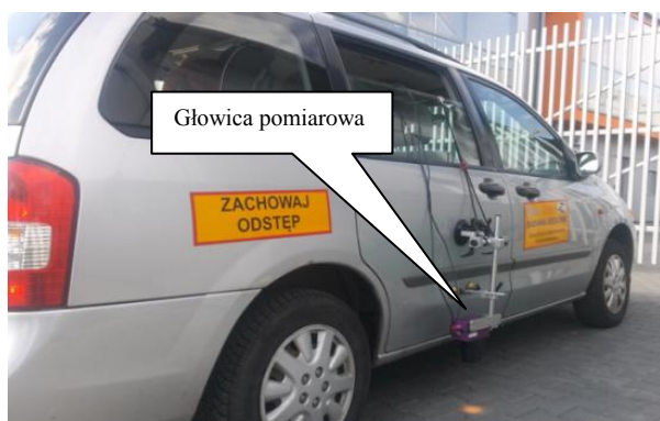
Rys. 2. Widok samochodu przygotowanego do badań z zamontowanym czujnikiem pomiarowym do drzwi bocznych
