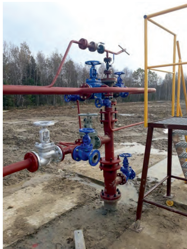
Rys. 4. Uzbrojony otwór eksploatacyjny [Polska Siarka Sp. z o. o.] Fig. 4. Operational sulphur well [Polska Siarka Sp. z o. o.]
