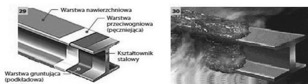
Rys.6. Zabezpieczenie ognioochronne farbą pęczniącą, zabezpieczony element stalowy podczas pożaru [6].
