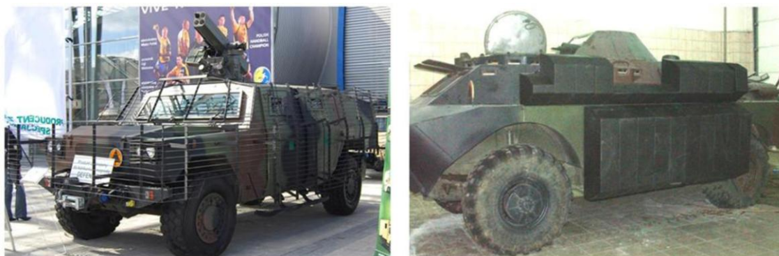
Rys. 2. Demonstrator z zamontowanymi ekranami prętowymi oraz pojazd BRDM z kasetami typu NERA
