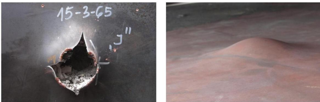
Rys. 4. Efekty zastosowania osłony kompozytowej – brak penetracji
