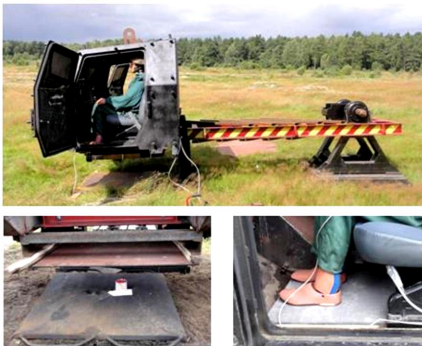
Rys. 5. Stanowisko badawcze do badania skutków wybuchu miny
