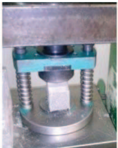
Rys.3. Próbką badana umieszczona w szczękach prasy hydraulicznej podczas pomiaru siły zginającej oraz ściskającej
