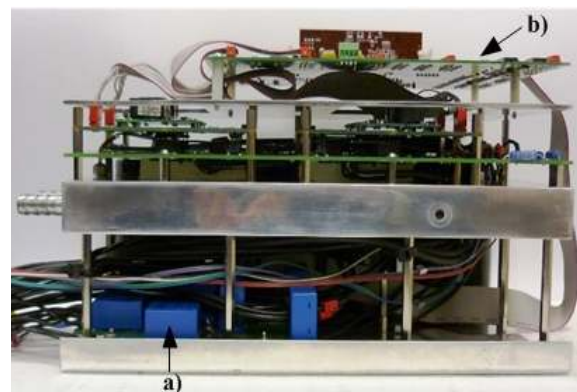
Rys. 6. Przekształtniki DC/DC – widok z boku: a) płyta układów pomiarowych, b) płyta interfejsu z mikrokontrolerem
